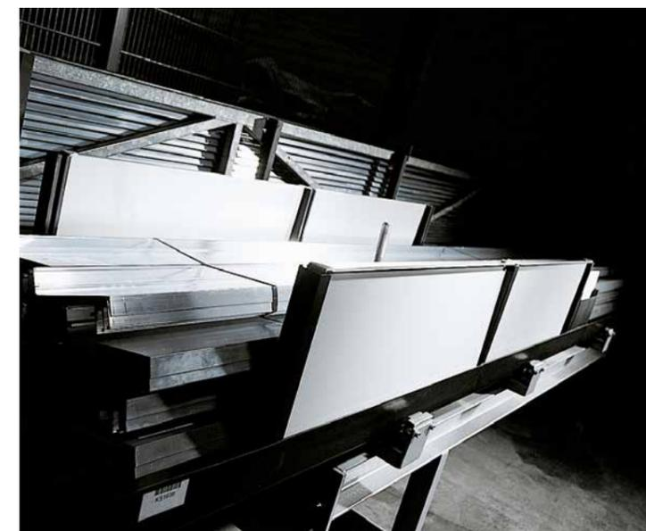
Einfach einhängbare Seitenwände für labiles oder empfindliches Material.
