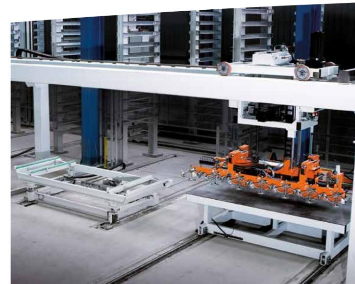
Automatische Kommissionierstation mit Vakuum-Transportanlage.
