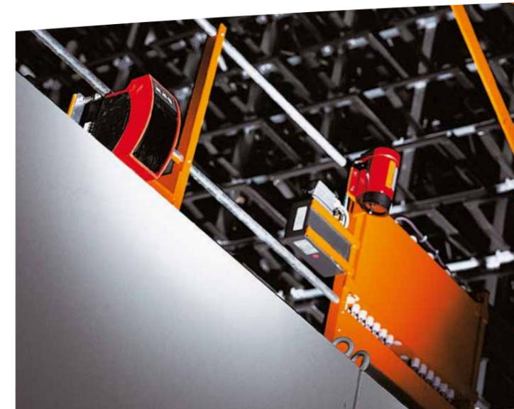
Datenlichtschranke und Laserachse sorgen für sichere Datenübertragung und störungsfreie Positionierung des Regalbediengerätes.
