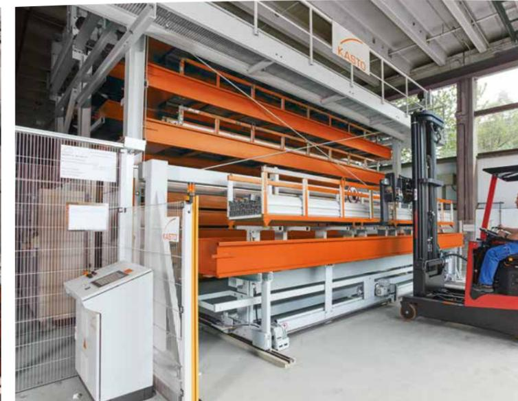
Einlagerstation mit Materialanschlagportal und integrierter Aushubeinrichtung gewährleistet einfaches Einlagern mittels Hubstapler.
