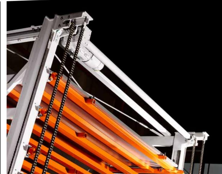
Stationärer Hubwerksantrieb mit Gleichlaufwelle.
