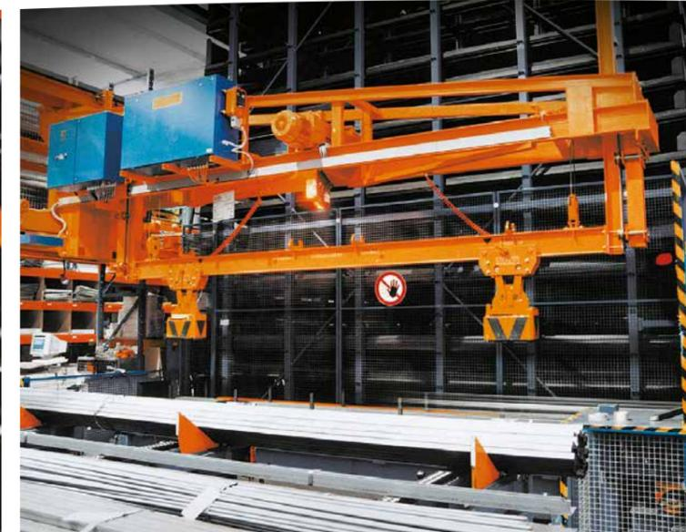
Das Kommissioniergerät ermöglicht eine ergonomische und schnelle Materialentnahme.
