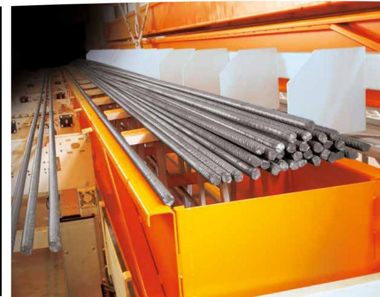
Querstation-Kettenförderer mit Aushub.
