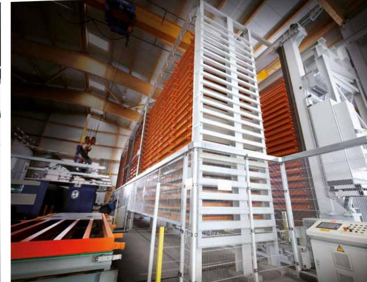
Lagerung von Blechpaketen und Auslagerstation zur manuellen Beschickung einer Laserschneidmaschine.
