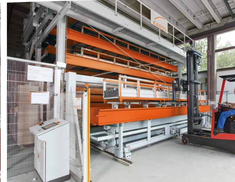
Station de stockage avec portique à butée pour matériaux et dispositif de levage intégré permettant un stockage facile grâce à un chariot élévateur.
