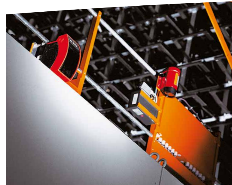
La barrière immatérielle et l'axe laser assurent une transmission précise des données et un positionnement précis du transstockeur
