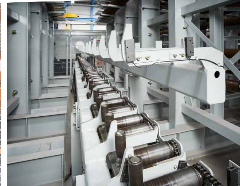
Le poste de changement rapide KASTO minimise les temps morts lors du changement de commande.
