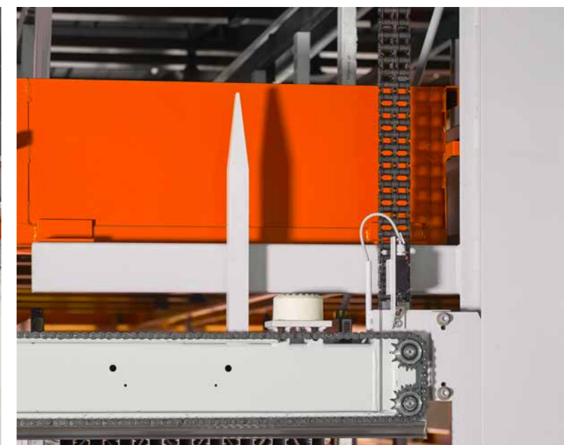
Station de stockage avec portique à butée pour matériaux et dispositif de levage intégré permettant un stockage facile grâce à un chariot élévateur.
