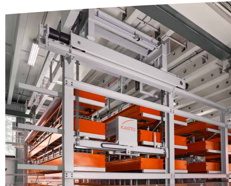
Le dispositif de levage à chaînes du transstockeur : robuste et d'une grande longévité.
