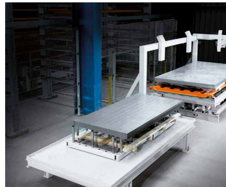
Station de préparation de commandes automatique avec système de transport de levage à dépression
